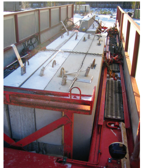
Seinäelementtien kuljetukseen on kehitetty myös erikoiskalustoa. Huomaa allasauton korkeat sivulaidat.
