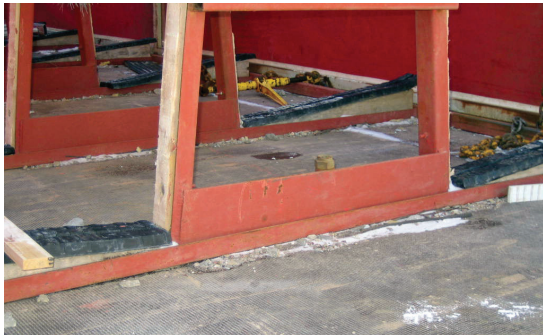
Siirrettävät pukit kiinnitetään lavaan toispuoleisen kuormituksen aiheuttaman kaatumisen estämiseksi.
